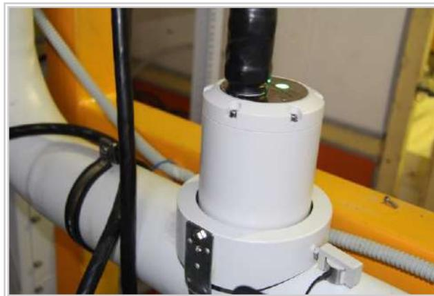
Echo является контактным прибором и устанавливается непосредственно вблизи колена трубы на расстоянии не менее 2x метров от фонтанной арматуры при помощи монтажного основания и стяжного хомута входящих в комплект поставки.
